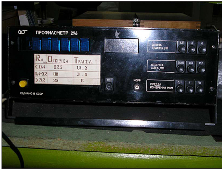
Рис. 4. Вимірювання шорсткості поверхні на профілометрі
