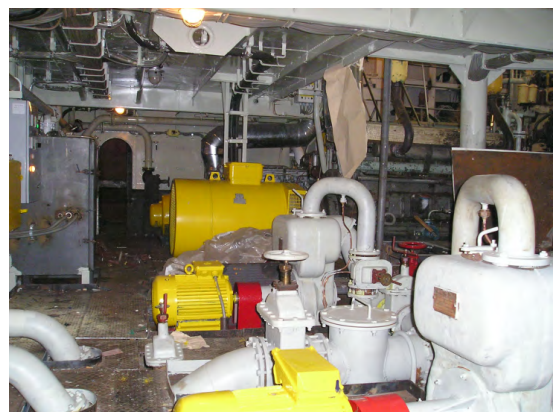
Рис. 3. Установка двигателя балластного насоса на буксире «Челси-4»
