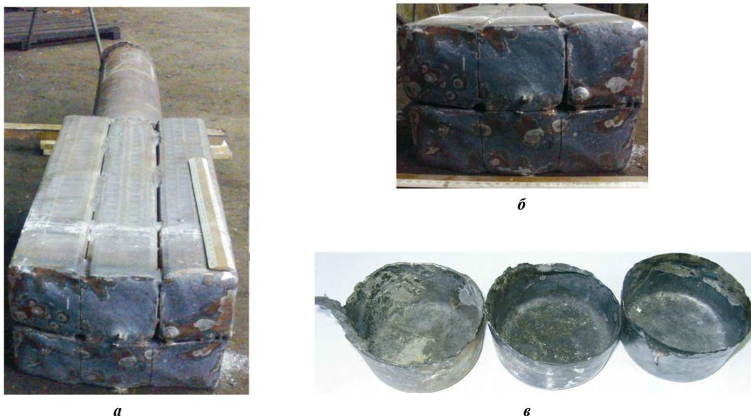
**Рис. 2.** Внешний вид расходуемого электрода ЭШП (пакета сваренных прутков) (а), торец оплавленного электрода с закристаллизовавшейся каплей металла (б) и пробы жидкого металла типа «чашечка» при ЭШП ЖМ (в)
