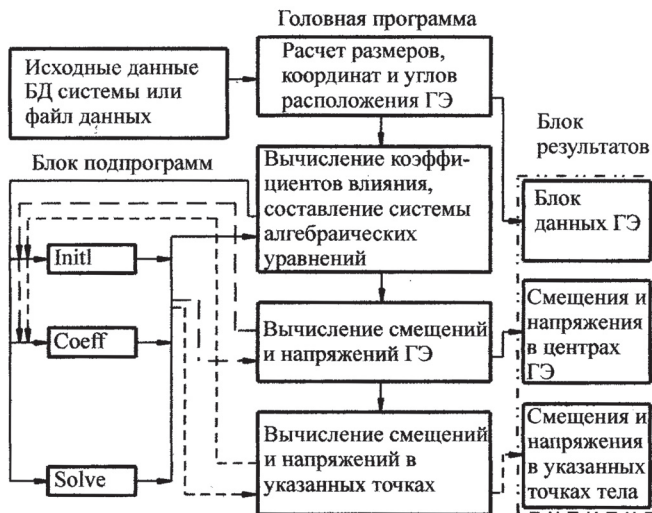
Рис. 2. Принципиальная схема взаимодействия расчетных процедур по МГЭ в составе отечественной САПР/АСТПП «Деймос»
