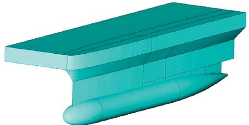
Рис. 2. Модель корпуса СМПВ переменной осадки
