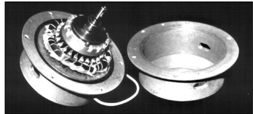
Рис. 9. Внешний вид аксиального двухроторного асинхронного двигателя
