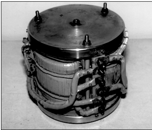
Рис. 5. Трехфазный компактный трансформатор с симметричным пространственным магнитопроводом
