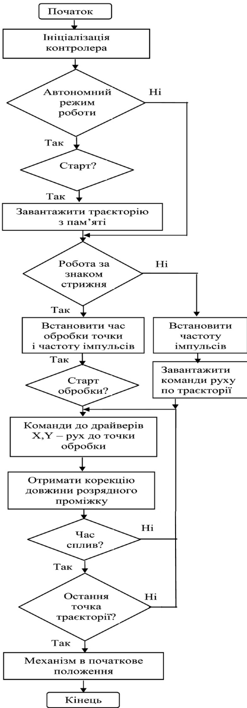
Рис. 2. Алгоритм роботи програмне забезпечення центральної мікропроцесорної системи керування електророзрядної технології очищення виливків
