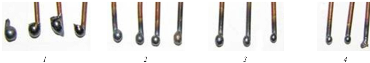
Рис. 2. Форма застиглих крапель на електродному дроті
