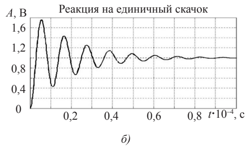
Рис. 5. График переходного процесса в нескорректированной (а) и в скорректированной (б) системах
