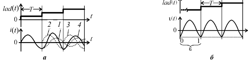
Рис. 2. Составляющие тока контура с (а) и стационарный процесс изменений тока контура под воздействием ступенчато возрастающего напряжения (б), кривые 1, 2, 3 – переходные функции тока h_i(t) , h_i(t - T) , h_i(t - 2T) соответственно, 4 – ток контура i(t) , T – период коммутации
