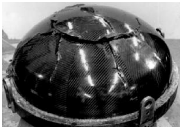
Рис. 1. Углепластиковая торосферическая оболочка диаметром 0,8 м после разрушения [7]
