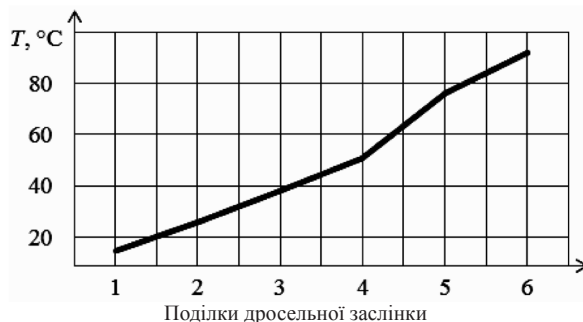
Рис. 3. Графік залежності температурних режимів при регулюванні температури за допомогою заслінки
