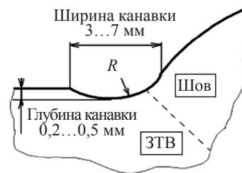
Рис. 1. Геометрические параметры канавки, образованной после применения ВМП сварного соединения с бойками различного диаметра: ЗТВ — зона термического воздействия
